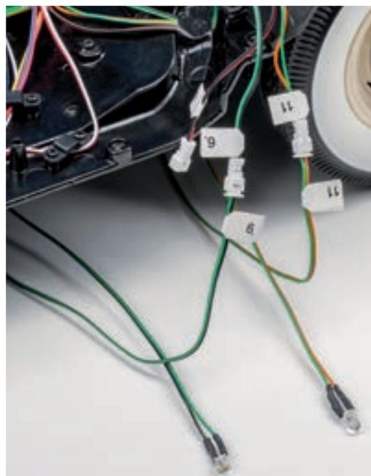
Подключите к проводам «6» и «11», расположенным возле заднего левого колеса, светодиоды плафона освещения салона (маркировка «6») и подсветки номерного знака (маркировка «11»).
