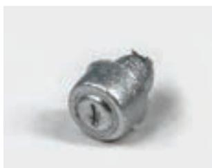
Вставьте замок зажигания в свободное отверстие панели приборов, расположенное правее выреза для рулевой колонки. Совместите крепежный штифт замка зажигания с отверстием и плотно прижмите деталь к панели приборов. Старайтесь зафиксировать замок зажигания таким образом, чтобы прорезь для ключа на нем была расположена вертикально.
