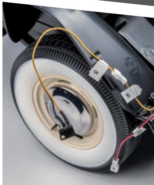
Аналогичным образом подключите задний выключатель потолочного плафона (маркировка «5») к проводу, расположенному перед задним правым колесом.
