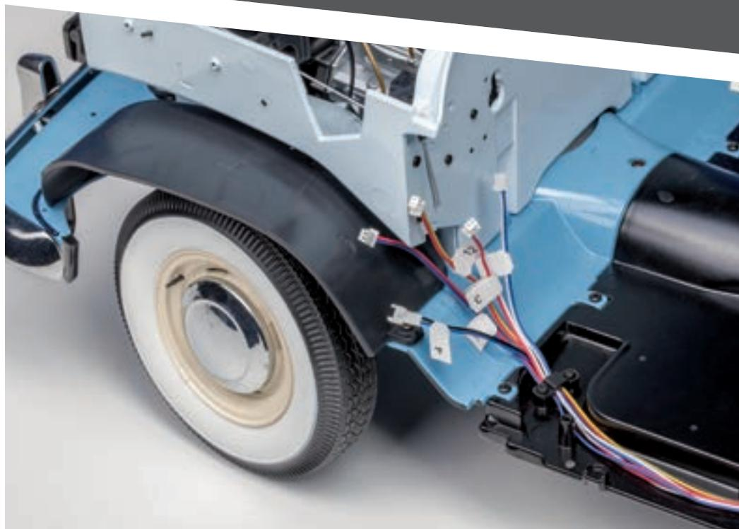
Подключите передний выключатель потолочного плафона (маркировка «4») к ответному проводу, расположенному позади переднего левого колеса. Плотно соедините разъемы между собой до характерной фиксации защелок. При соединении или разъединении разъемов старайтесь не прилагать усилий к проводам. В противном случае может быть нарушен электрический контакт между проводом и металлической клеммой разъема.
